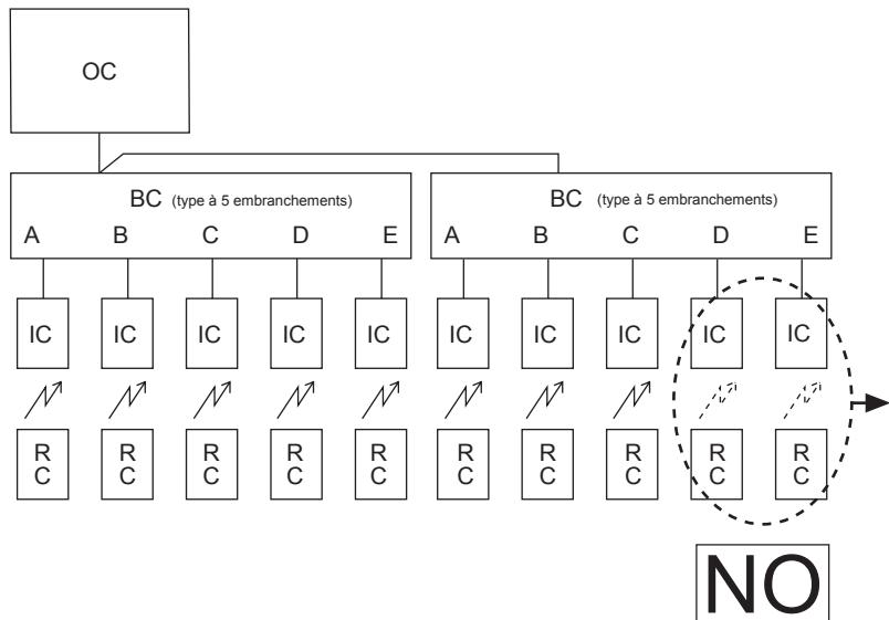
1. Possibilité de raccorder jusqu'à 2 boîtiers de dérivation à un seul appareil extérieur.
