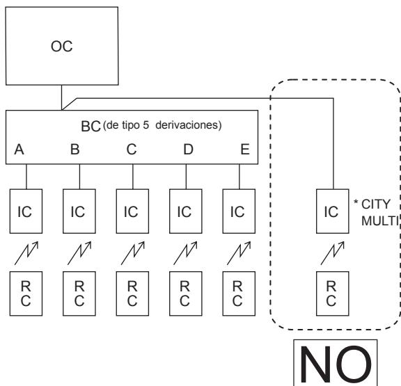
3-4. Conexión del controlador remoto M-NET
