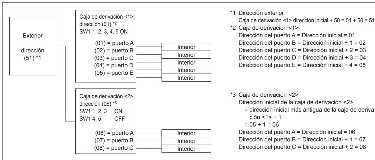
Ej2. Exterior + Derivación <1> (Interior A, C, E) + Derivación <2> (Interior A, C, E)
