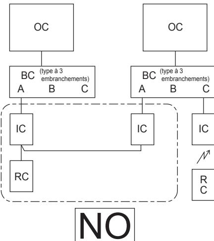
3-3. Raccordement d'un adaptateur M-NET à l'appareil extérieur
