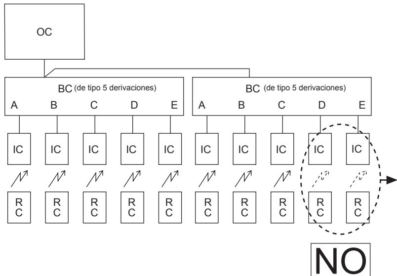
1. Se puede conectar un máximo de 2 cajas de derivación a una unidad exterior.
