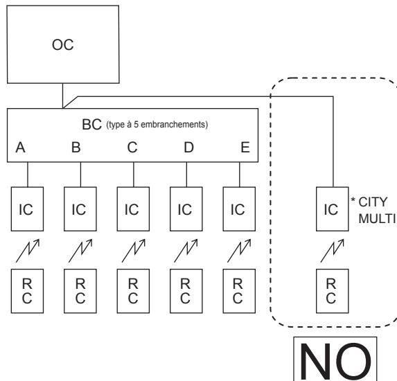
3-4. Raccordement de la télécommande M-NET
