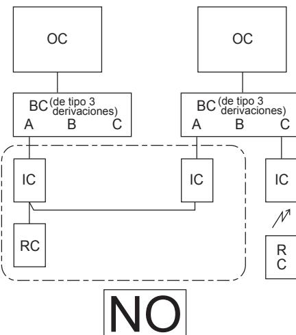
3-3. Conexión del adaptador M-NET a la unidad exterior
